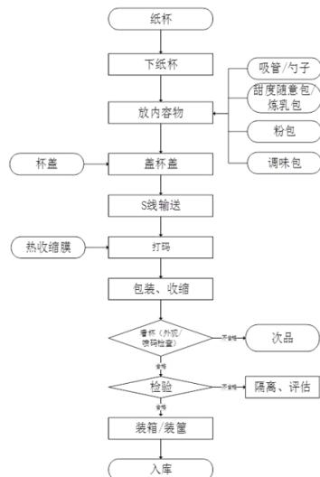
图 3.2 生产工艺流程图
