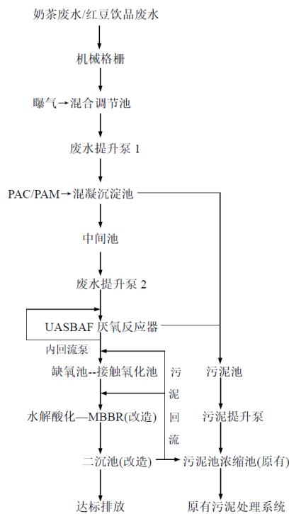
图 3.3 废水处理工艺流程图
